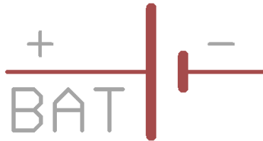
Abb. 2: Schaltzeichen einer Batterie / Batteriezelle
