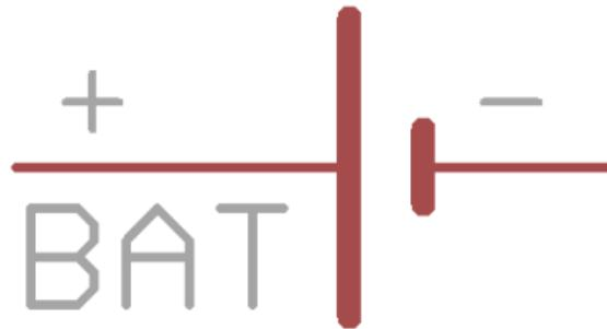
Abb. 2: Schaltzeichen einer Batterie / Batteriezelle
